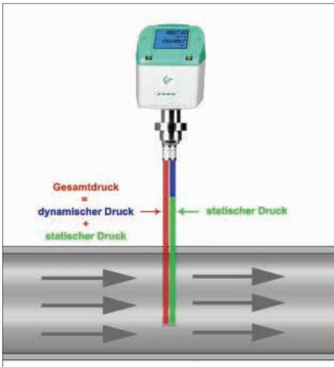
Durch den integrierten, präzisen Differenzdrucksensor wird der Differenzdruck/Staudruck an der Sensorspitze gemessen. Dieser ist abhängig von der jeweiligen Gasgeschwindigkeit. Anhand des Rohrdurchmessers kann somit einfach auf den Durchfluss geschlossen werden.
