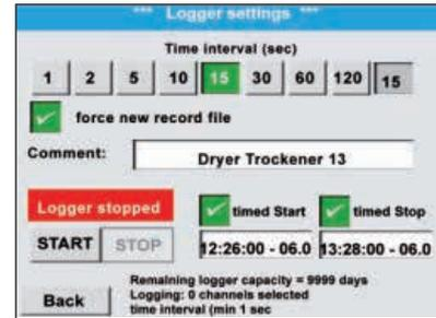
Bis zu 100 Mio. Messwerte können gespeichert werden. Jede Messung kann mit einem Kommentar, z.B. Messortname gespeichert werden. Das Zeitintervall kann frei bestimmt werden.
