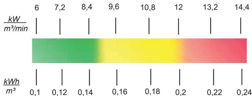
Eine typischer spezifischer Leistungsbedarf eines öleingespritzten Kompressors kann wie folgt aussehen.
