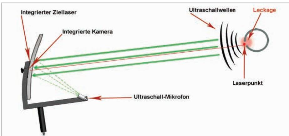
Durch die Bündelung der Ultraschallwellen im Parabolspiegel können selbst kleinste Leckagen von 0,8 l/min (ca. 8 € p. a.) in einer Entfernung bis 10...15 m punktgenau ( $\pm 15$  cm) lokalisiert werden.
