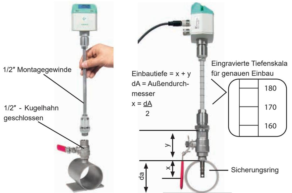
2) Wenn keine passende Messstelle mit 1/2" - Kugelhahn vorhanden ist, gibt es zwei einfache Möglichkeiten eine Messstelle einzurichten:
