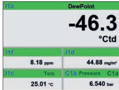
Alle physikalischen Messgrößen der Feuchtemessung werden automatisch berechnet. Beim DP 510 werden zusätzlich die Messwerte des externen Fühlers angezeigt.
