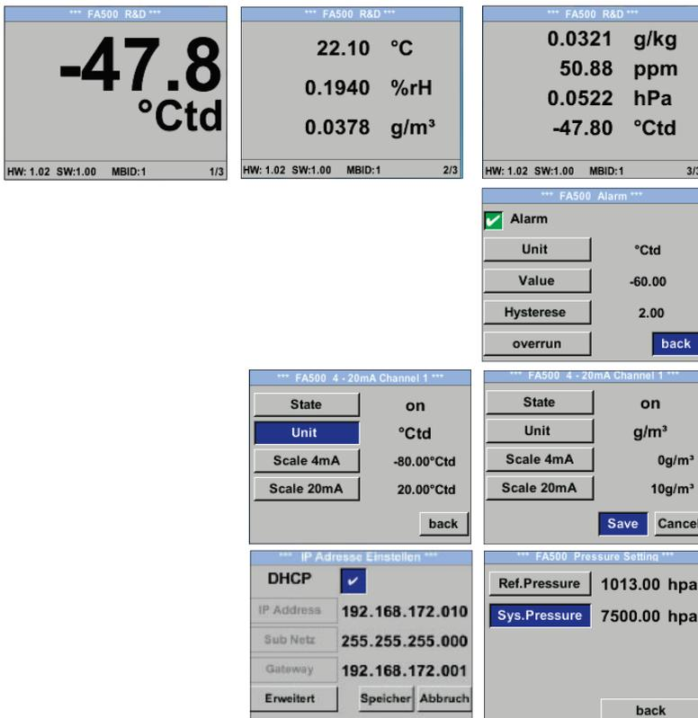
Das integrierte Display zeigt den Taupunkt groß sowie weitere Feuchtemessgrößen auf 2 weiteren Displayseiten. Mit der Pfeiltaste kann zwischen den Displayseiten geblättert werden.
