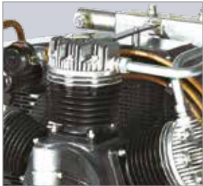
Hochwirksame Kühlung Aluminium-Zylinderköpfe mit hervorragender Wärmeabführung für längere Lebensdauer.
