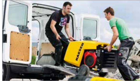
Die kleinsten MOBILAIR-Kompressoren betreiben Druckluftspaten, -hämmer, -bohrmaschinen, -sägen, -schrauber, -schleifer oder Erdraketen. Die 15-bar-Version eignet sich ideal zum grabenlosen Verlegen von Glasfaserkabeln oder für Dichtheitstests. Optional sorgt ein externer Druckluft-Nachkühler für kühle, kondensatfreie Druckluft.
